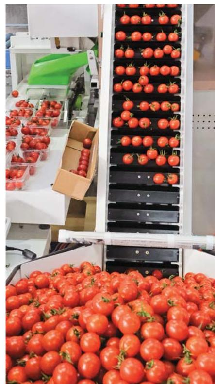
選別が終わると、4台のパック詰め機へ。自動計測で210g以上にパック詰めされたものを手作業できれいに並べて、出荷調整完了!
