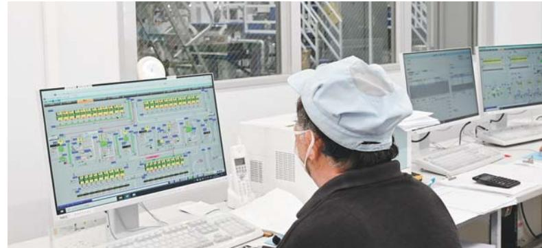
FAシステム(工程制御)を用いて中央操作室のPCで、荷受から出荷までの加工工程を一括操作監視し、製品加工に伴う履歴帳票も瞬時に自動作成します
