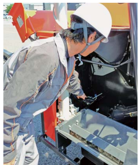
4 【電装部】 バッテリーの劣化具合を測定して電装機器の作動を点検します
