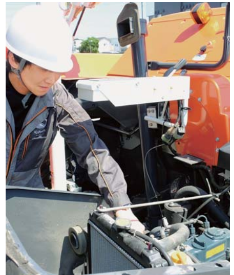
1 【エンジン部】 オイル類の漏れ、劣化を確認。エアクリーナー等は清掃して組み付け、エンジントラブルを防止します
