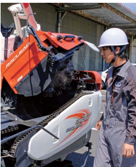
6 【脱穀部】 刃やベルトの摩耗具合を確認・調整します
