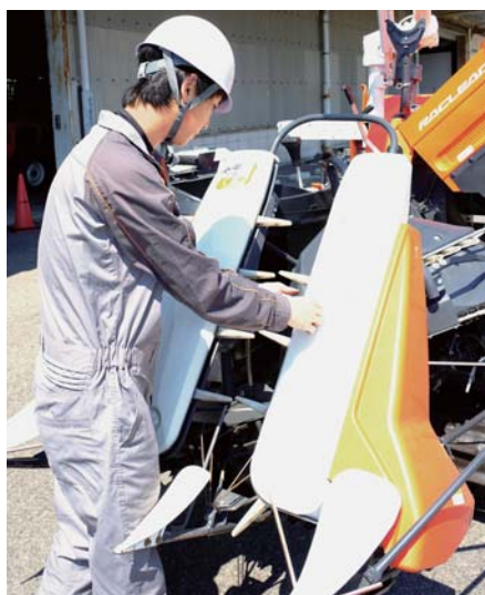
5 【刈取部】 刃やチェーンの摩耗具合を確認・調整します
