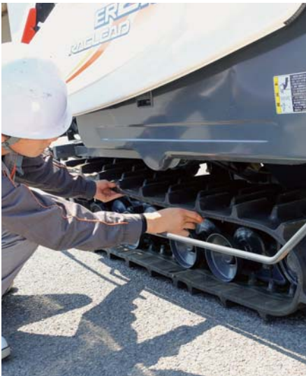
3 【走行部】 クローラー等の摩耗具合を確認してブレーキ等の作動を点検します
