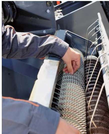
2 【排わら部】 刃やベルトの摩耗具合を確認・調整します
