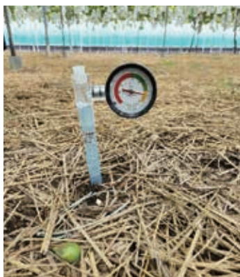
写真1 土壌水分計の設置
